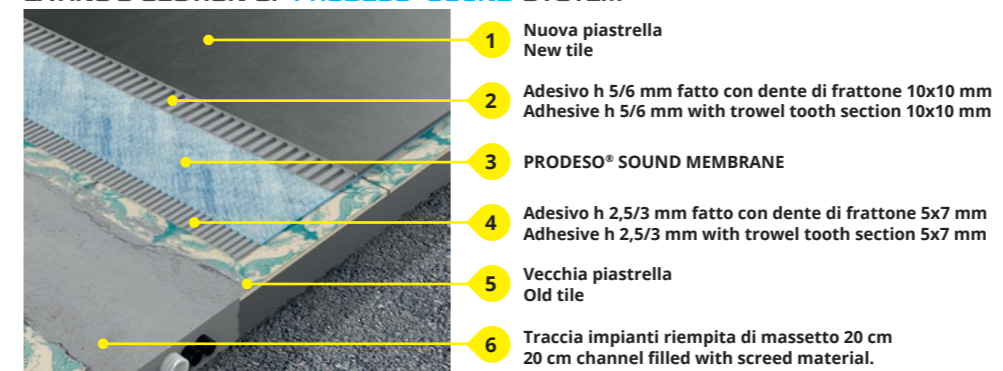
SEZIONE DI POSA DI PRODESO® SOUND SYSTEM LAYING'S SECTION OF PRODESO® SOUND SYSTEM
