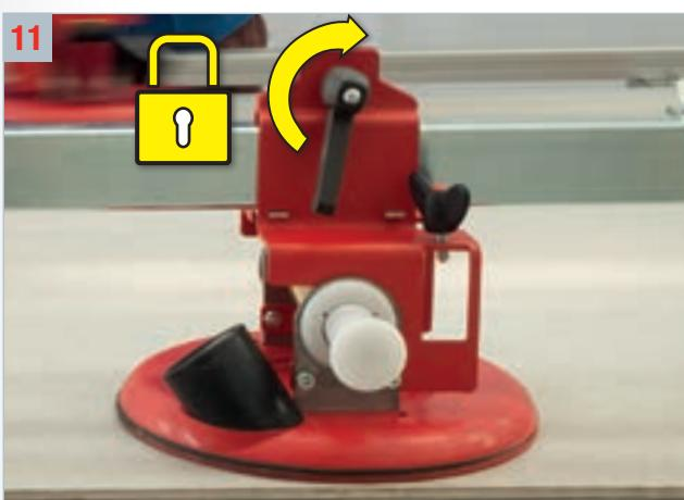
**IT** ATTENZIONE: controllare sempre l'integrità delle ventose. Prima della movimentazione verificare il vuotometro di sicurezza.
